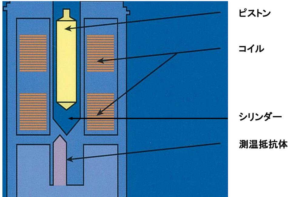
センサーは断面図の通り測定対象液を入れるシリンダ、その周囲に2つのコイルが配置されています。そして、測定液をシリンダに入れピストンと呼ぶ移動物を挿入します。ピストンはコイルの磁力により液体中を移動します。当然、一定距離を移動する時間は液体の粘性抵抗により変化します。この移動時間を測定することで粘度を導いています。さて、移動時間の測定手法は2つのコイルの内、1つがピストンを引っ張るコイル、もう1つのコイルがピストンの移動時間を検出するコイルとして働きます。一方向の測定が終了しますとコイルの動作が反転してピストンを逆方向へ移動させながら同様に粘度を測定します。この測定往復動作は電源をOFFしない限り連続し、粘度測定値も連続して出力されます。
